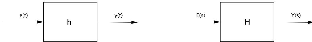
Figure 27: Domaine temporel: y(t) = h(t) * e(t) et domaine fréquentiel: Y(s) = H(s) \cdot E(s) .
